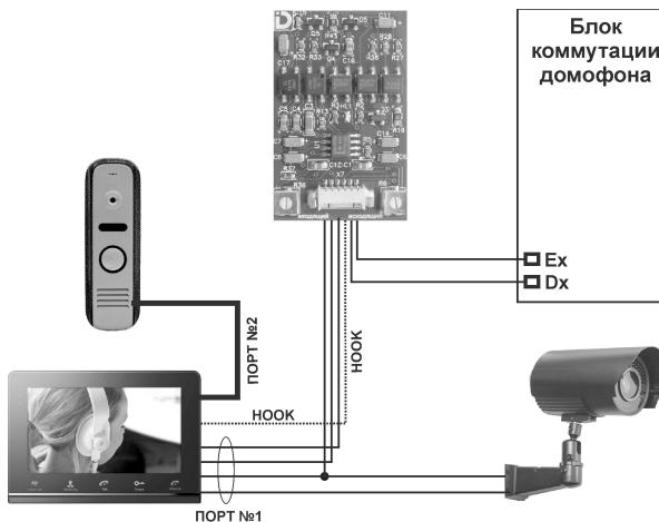
Подключите модуль сопряжения к остальному оборудованию, как показано на схеме. Если выход сигнала "HOOK" в Вашем видеодомофоне не предусмотрен, зелёный провод никуда не подключайте.
