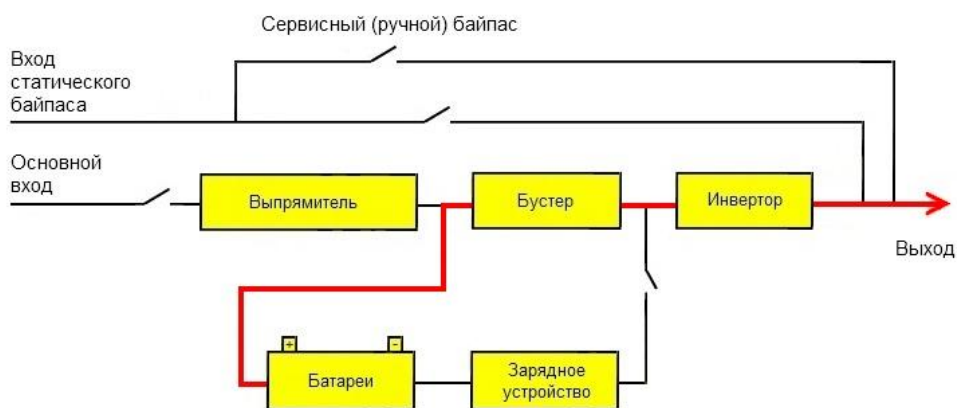
Схема работы в режиме от батарей.
