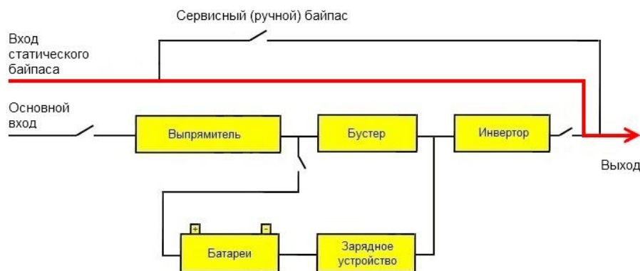
Схема работы в режиме неисправности.
