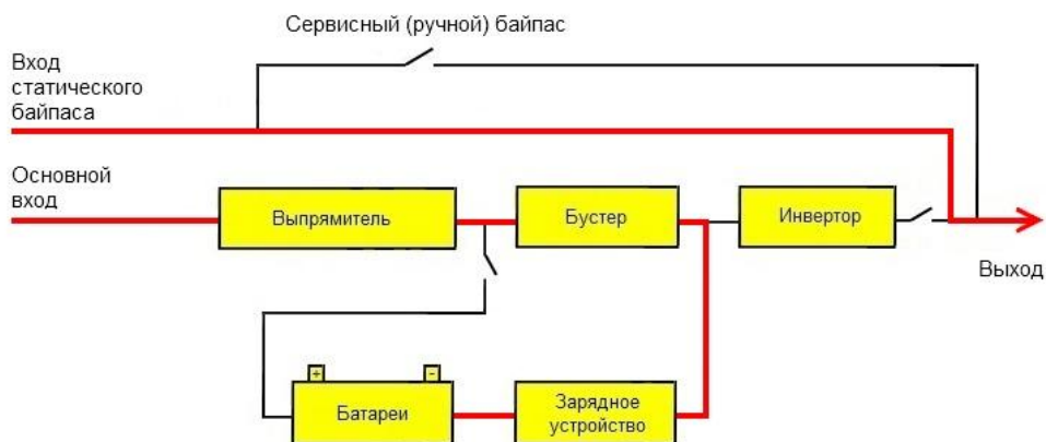
Схема работы в режиме статического байпаса
