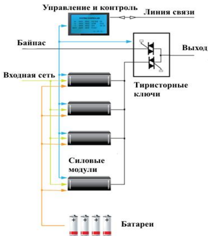
Рис.3-1 Блок-схема принципа работы ИБП серии Monolith XM
