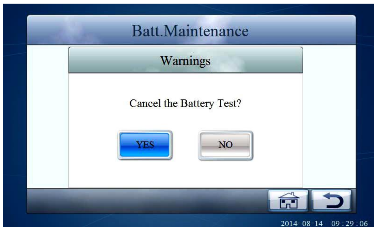
Рис.7-37 Подтверждение завершения проверки батарей.
