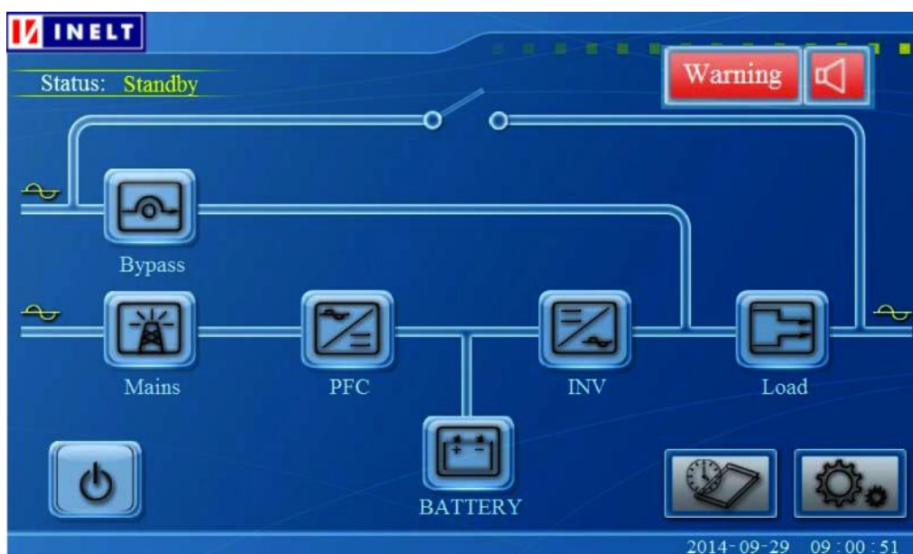
Рис. 7-8 Защита от сбоя / неисправности (ИБП заблокирован, нагрузка не поддерживается).
