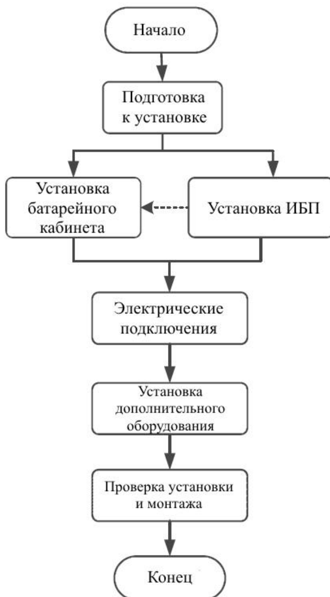
Рис.4-1 Блок-схема установки и монтажа ИБП серии Monolith XM
