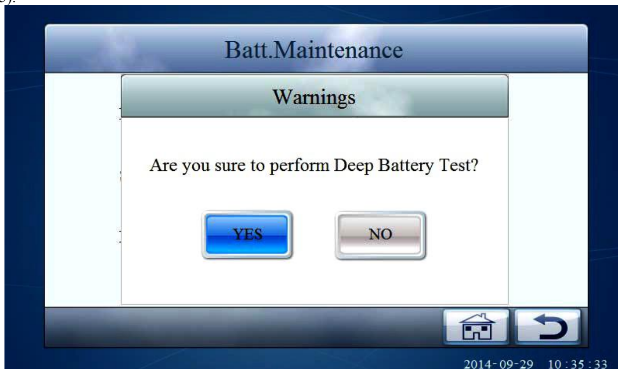
Рис.7-35 Подтверждение начала глубокой проверки батарей.
